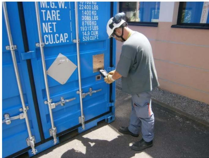
CNPE 费森海姆设施与越来越多的核电设施一起实施 Nexess 的 NexCap<sup>®</sup> 系统，以实现集装箱管理、跟踪和报告流程的自动化。Nexess 是能源和航空航天行业的 RFID 集成专家，总部位于法国索菲亚安提波利斯。CNPE 费森海姆工厂的 NexCap 移动资产管理系统使用 Nexess 软件、带有集成 RFID 阅读器的摩托罗拉 Workabout Pro 3 手持电脑和 Xerafy Micro XII 标签用于识别和审核存储容器，记录所有移动和位置，通过无线 LAN 连接向工人提供拣货和上架指令。该系统还为报告和监管文件收集位置和状态数据，并支持材料管理和维护操作。
